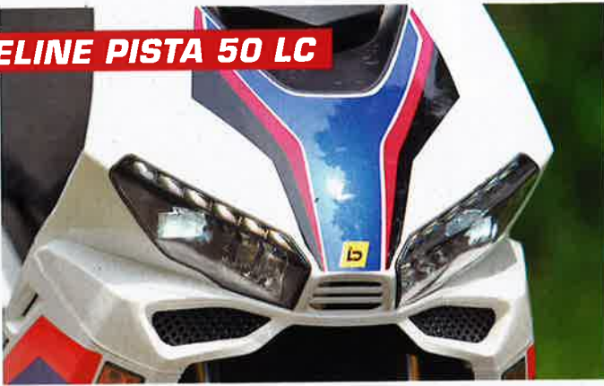
Erster 50er mit LED-Scheinwerfer für Fern-Abblendlicht
