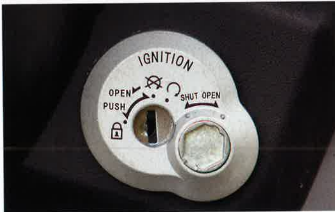
Das Zündschloß ist zusätzlich verriegelbar gegen Diebstahl
